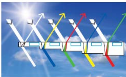
Рис. 2. Изменение эффекта интерференции в зависимости от толщины слоя диоксида титана.
